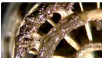
有害细菌在水垢孔隙中生长
